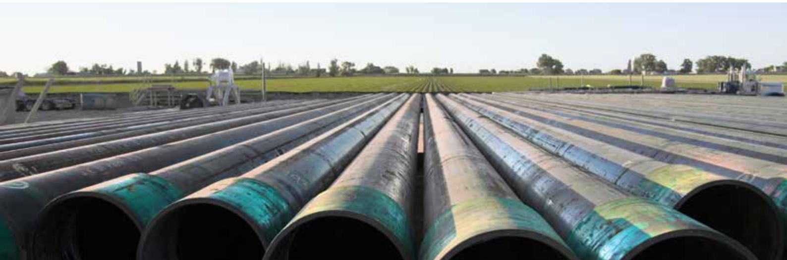
FÜR EINE BOHRUNG VORBEREITETES GESTÄNGE AUF DEM VAIL PAD, USA
